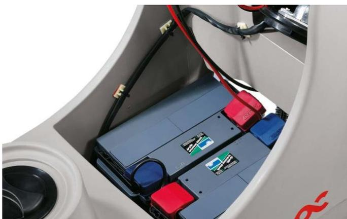
Батарейный отсек в машине имеет легкий доступ для контроля аккумуляторов. Машина работает от быстрозарядной литиевой батареи 24В, которая не требует технического обслуживания. Заряжаются батареи от встроенного либо внешнего зарядного устройства всего за 3 часа.
