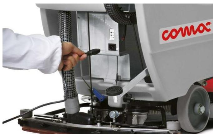
Машина собрана на несущей металлической раме. Балка сквиджа в отличие от конкурентов поднимается тросом и металлическим рычагом.
