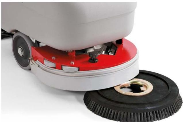
Щеточный узел поломоечной машины Comac Abila имеет очень удобную систему крепления и фиксации щетки. Вам не надо проводить ручные манипуляции под кожухом щеточного узла. Достаточно положить щетку на пол щетиной вниз, накрыть сверху щеточным узлом примерно посередине щетки, и нажать кнопку включения двигателя. Щетка сама зафиксируется на креплении. Снимать щетку так же легко.
