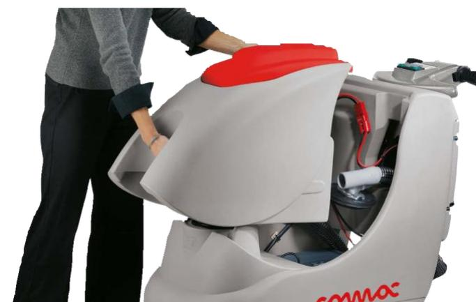
Съемный бак для грязной воды, изготовлен из полиэтилена высокой плотности. Бак является ударопрочным, устойчивым к действию мощных химических средств, легко моется.
