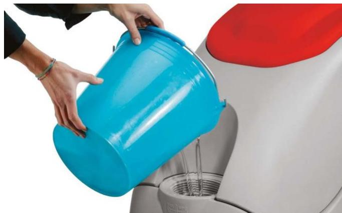
Отверстие для залива воды расположено с передней части машины и имеет форму воронки. Поэтому заливать чистую воду очень легко, и брызги при этом отсутствуют. Также в отверстие интегрирован сетчатый фильтр для улавливания мусора и возможных жестких примесей воды.
